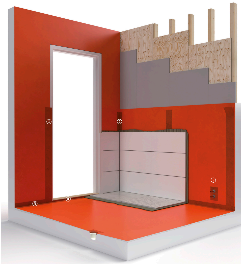
BILD D – Rörgenomföring i vägg Exempel på fixerad rörgenomföring med rör-i-rör-system. 1. Fixering
